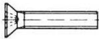
Gewinde: M 3; Länge = 16mm; Werkstoff = A2
