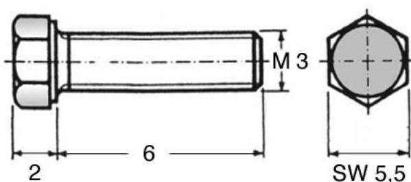
Gewinde: M 3; Länge (6)= 10mm; Werkstoff = A2
