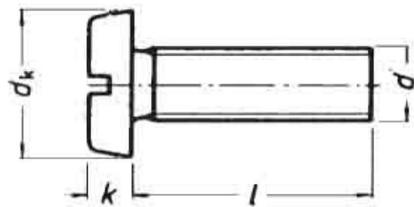
Gewinde: M 4; Länge = 16mm; Werkstoff = A2
