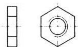
Gewinde: M 3; Höhe = 1,8mm; SW= 5,5; mit Fase; niedrige Bauform
