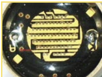
Abb. 4: LED-COB-Modul für Signal- und Lichttechnik/ Traffic- and Lightapplications
