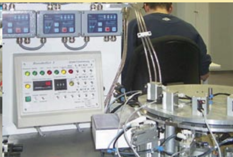
Teilautomatischer LED-Bestückungsautomat Partial automatic LED-selection-machine
