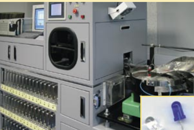
Vollautomatischer LED-Selektionsautomat Automatic LED-selectionmachine
