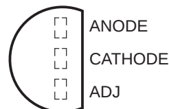
LM336-2.5, LM336B-2.5 . . . LP PACKAGE (TOP VIEW)
