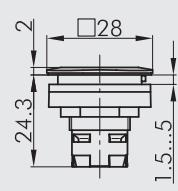
**Drucktaste mit Ringbeleuchtung**
