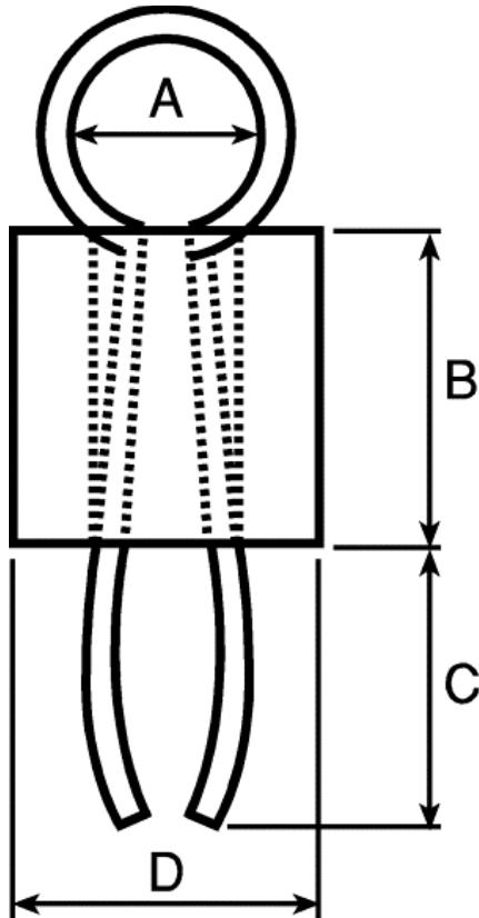
Klemmen sind eine einfache Lösung, wenn Sonden oder Krokodilklemmen schnell und effizient angeschlossen werden müssen. Die Ösen sind ebenfalls ideal zur Anbringung von diskreten Drähten oder Komponenten geeignet, die häufig ausgetauscht werden müssen.
