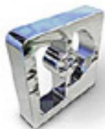
Print-Steckblockklemme, bestehend aus Grundgehäuse mit Lötstiften und Steckerteil mit Schraubanschluss, Raster: 5,08 mm, Polzahl: 4, Nennstrom: 16 A, Bemessungsspannung: 250 V
