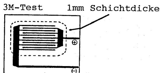
F) Elektrolytische Korrosionsbeständigkeit nach ASTM D 3482\*,
