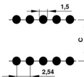
SMD-Fassung für DIL-IC Kontaktobерfläche: verzinnt Speziell in den Isolierkörpern integrierte Kontakte passen sich der evtl. ungleich verteilten Lötpaste an. Version DIL SMD M mit Mittelsteg für Vakuum bestückung.
