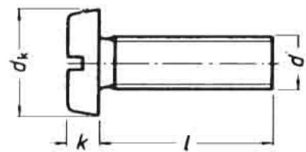
Gewinde: M 3; Länge (l)= 10mm; Werkstoff = A2
