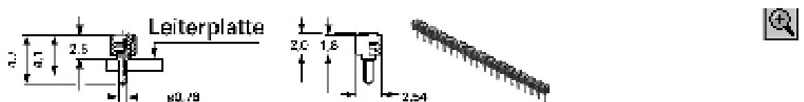
superflach, Bauhöhe über der Leiterplatte nur 2,5 mm, 64polig, lötdicht, geschlossener Isolierkörper aus Polyester, mit 30 % Glasfaseranteil. Hülse: verzinnt, Lötstiftdurchmesser: 0,76 mm, Feder: vergoldet, Betriebstemperatur: -55 bis +125 °C (5,0 s bis +260 °C), Strombelastbarkeit: 1,0 A, Betriebsspannung: 10 mV bis 60 V, Durchschlagsspannung: 1000 V, Durchgangswiderstand: 7,0 mOhm, Rastermaß: 2,54 mm.
